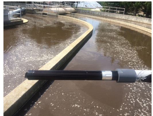
Die FDO®-Sonde (optisch gelöster Sauerstoff)
